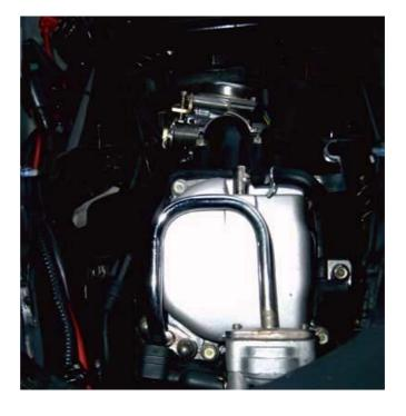
In diesem Bild sehen wir den Zylinderkopf-Deckel hinter dem sich die einzustellenden Ventile verbergen.
